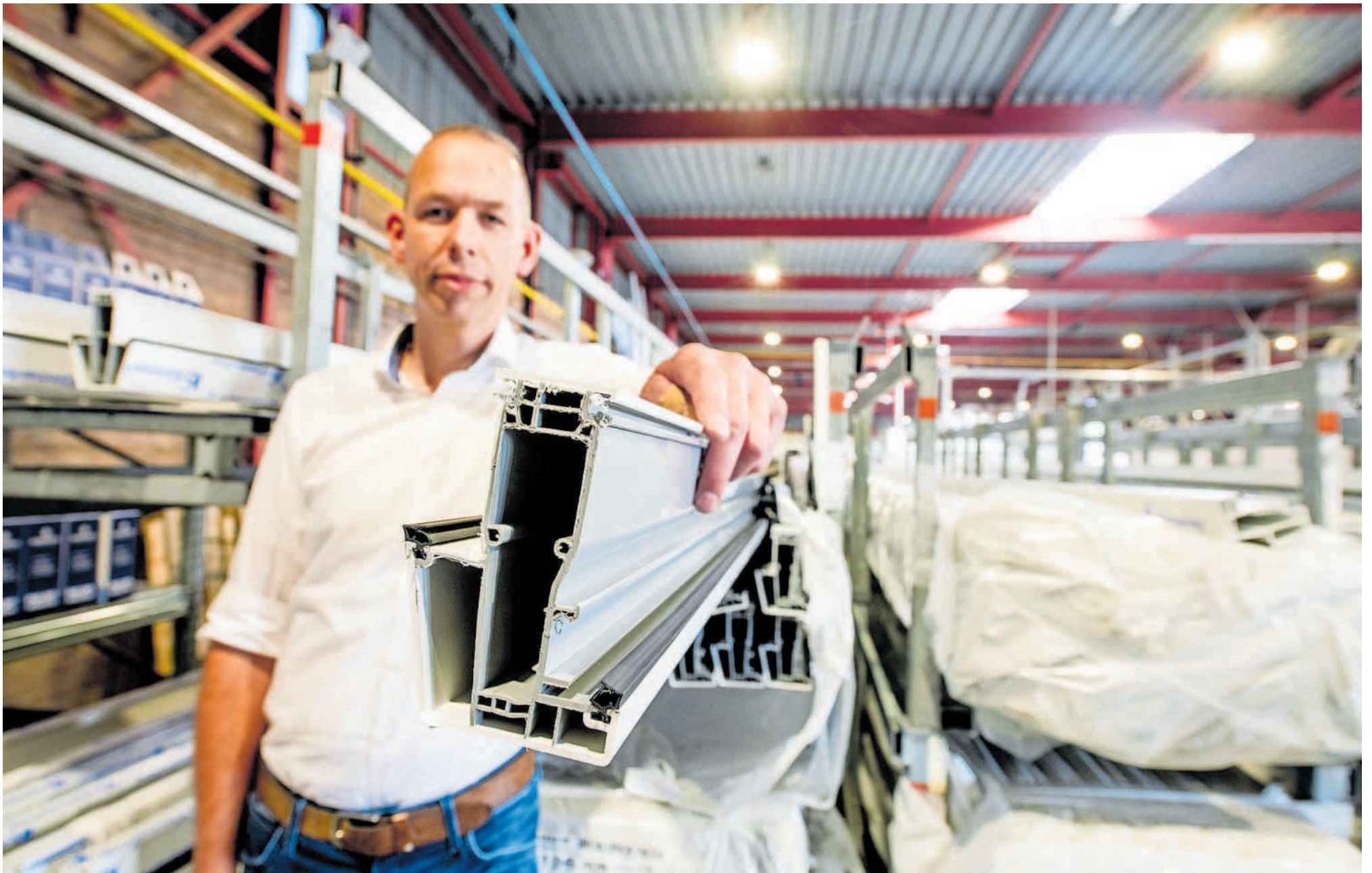
Jan Slagman van Europrovyl met een profiel van fossielvrij en gerecycled PVC. De grijze binnenkant van het profiel is van het gerecyclede materiaal.
